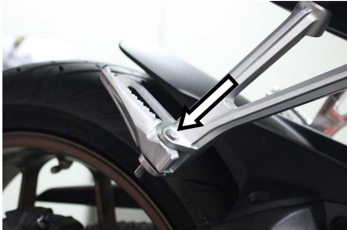
IT · Inserire nel foro della pedana passeggero DX il perno fornito
